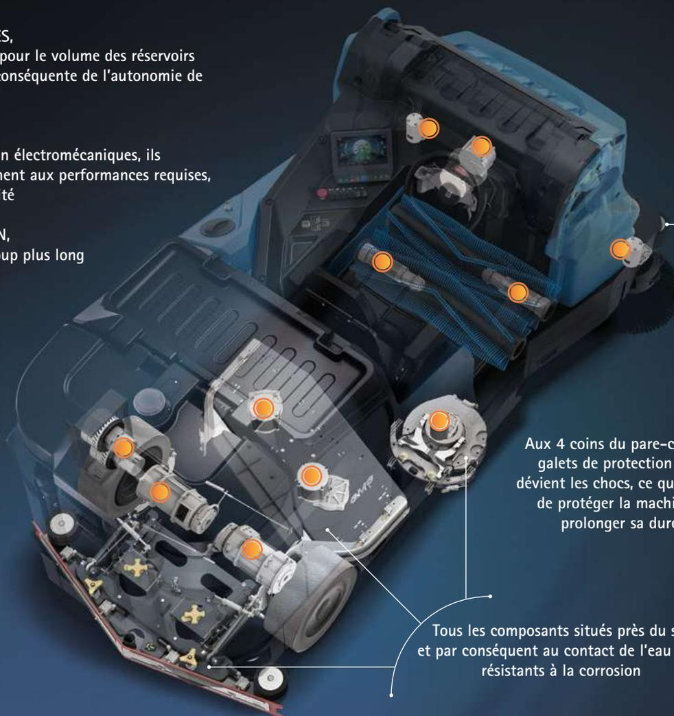
Aux 4 coins du pare-chocs, les galets de protection intégrés dévient les chocs, ce qui permet de protéger la machine et de prolonger sa durée de vie
