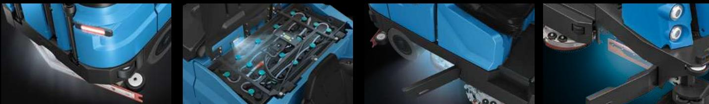
Le groupe de feux de service exclusif augmente la visibilité des parties pouvant être sujettes à des contrôles par l'opérateur, en éclairant les zones concernées avec des phares à LED
