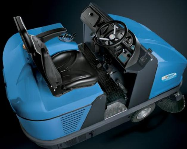
Le poste de conduite a été taillé sur mesure pour l'opérateur et créé pour rendre son travail le plus confortable possible : le volant a une inclinaison réglable tout comme le dossier du siège et les accoudoirs
