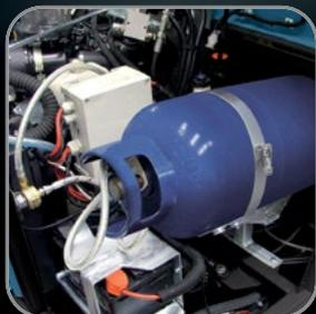
· La double alimentation essence/GPL permet l'utilisation de la machine avec un carburant écologique (GPL).
